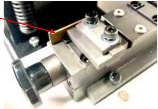
セットが完了しましたらウエーブキー用のカッターガイドにて複製してください
